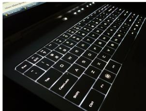
O teclado com luz de fundo dos laptops Dell tem diferentes estados de iluminação. Pressione a tecla <Fn> e a tecla de seta para a direita para alternar entre os vários estados de iluminação.
